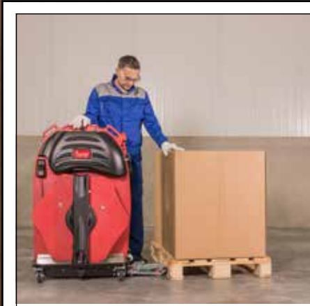
エルゴパックをパレットに載せた 梱包対象物の前に移動させると
